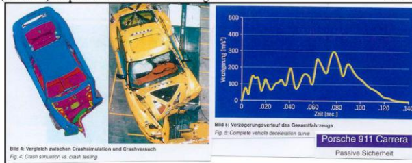
Bild 4: Vergleich zwischen Crashtestsimulation und Crashtest
