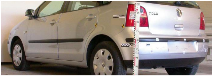
'AGU-Datenbank, Versuch Nr. SG_01' _delta \Delta v_{\text{Kompression}} = 3,1 km/h
