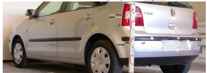
'AGU-Datenbank, Versuch Nr. SG_04' _delta \Delta v_{\text{Kompression}} = 7,6 km/h
