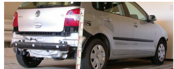
'AGU-Datenbank, Versuch Nr. HS_35' _delta \Delta v_{\text{Kompression}} = 7,65 km/h
