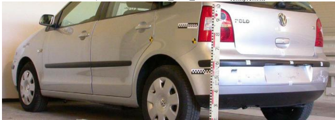
'AGU-Datenbank, Versuch Nr. SG_03' _delta \Delta v_{\text{Kompression}} = 6,4 km/h
