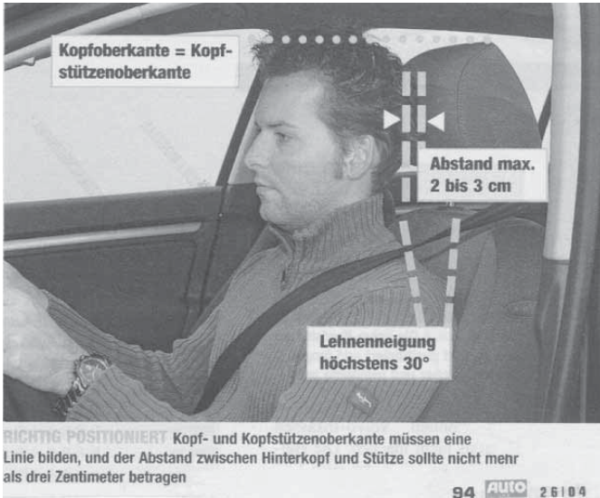
Abbildung 1: Zeigt die richtige Einstellung der Kopfstütze nach dem neuesten Wissenschaftsstand. Die Oberbegrenzung des Kopfes befindet sich auf Höhe der oberen Kopfstützenbegrenzung. Der Abstand des Kopfes zur Kopfstütze ist sehr klein. Bild: Zeitschrift „Auto Zeitung – Heft 26/2004, Bericht ‚Kopfstützentest‘“. Uwe Schmidt-Kasperek/Holger Ippen.
